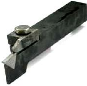
Рис. 1. Відрізний різець з бічною установкою БНП [4]
