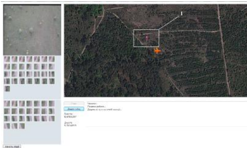
Рис. 3. Головне вікно системи після того, як користувачем було поставлено мітку про місцезнаходження літака в поточний момент часу (1 - мітка на карті)
