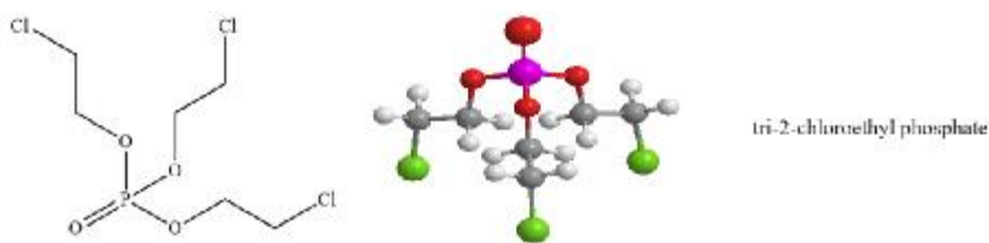
Рис. 3. Оптимизированна структура модели фрагмента пластификатора ТХЭФ
