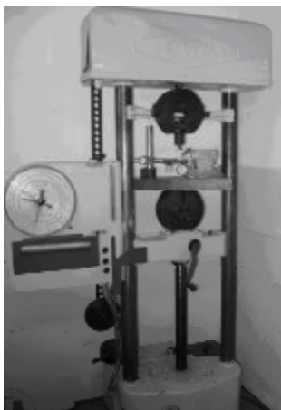
Рис. 9. Універсальна випробувальна машина типу УМ-5А з установкою для вимірювання переміщень голівки відрізного різця з бічною установкою БНП
