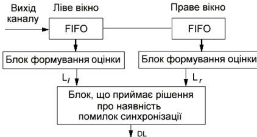
Рис. 2. Структурна схема пристрою виявлення бітових помилок
