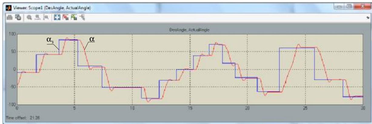
Рис. 14. Графіки сигналу задання та відпрацювання задачі системою
