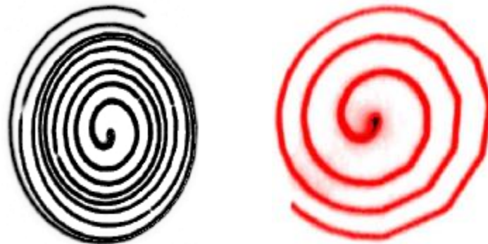
Рис. 8. Візуалізації форм руху дзеркального диску площиною стола
