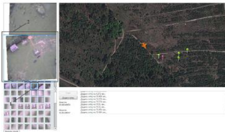
Рис. 6. Головне вікно ПЗ в момент виклику користувачем спливаючого вікна з зображенням відеокадру отриманого в момент захоплення чужорідного об'єкта (1 – чужорідний об'єкт; 2 – відеокадр у момент захоплення)
